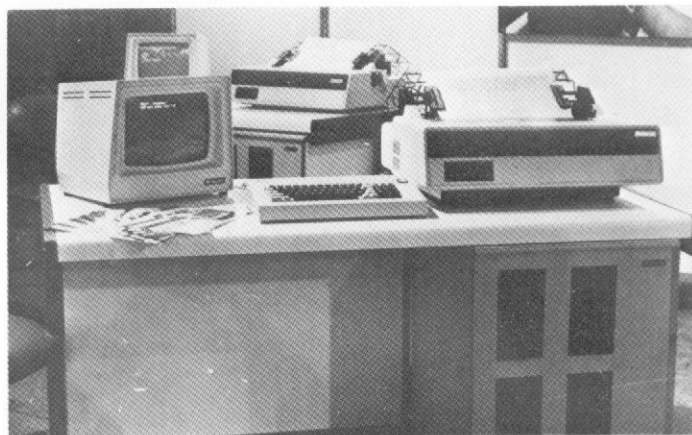
O Alfa 2064 comporta até quatro disquetes de 8" e é principalmente voltado para a área administrativa
